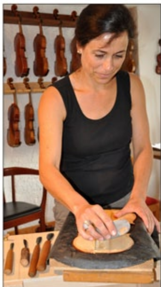
Mit einer Ziehklinge wird die Oberseite des Geigenkörpers ausgeformt.
